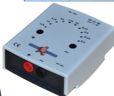
Inverseur tension alimentation Permet de créer une tension négative
